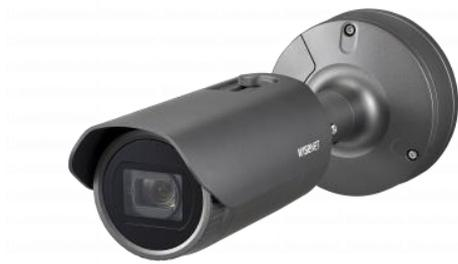
Dovranno essere telecamere fisse di ultimissima generazione con sensore CMOS da 1/1.8" a scansione progressiva da 5 Megapixel 3.096 (O) x 2.094 (V) e dispositivo WDR 120dB, illuminazione minima 0,07 lux (F1.2 1/30 sec ) in modalità a colori e 0.00 lux in modalità monocromatica con faro IR attivo e poter trasmettere le relative immagini codificate in H265 / H264 o MJPEG tramite interfaccia Ethernet RJ45.
