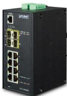
L'apparato IGS-12040MT è uno Switch Managed industriale a guida DIN, dotato di n. 8 porte 10/100/1000Mbps e n. 4 porte Gigabit TP / SFP. Si tratta di uno switch completamente gestito / configurabile e specificamente progettato per funzionare in modo affidabile anche in ambienti climaticamente impegnativi con temperature esterne da -40° a + 75°.
