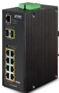
L'apparato IGS-10020HPT è uno Switch Managed industriale a guida DIN, dotato di n. 8 porte 10/100/1000Mbps Gigabit Ethernet IEEE 802.3af / 802.3at con Power over Ethernet e n. 2 porte Gigabit TP / SFP. Si tratta di uno switch completamente gestito / configurabile e specificamente progettato per funzionare in modo affidabile anche in ambienti climaticamente impegnativi con temperature esterne da -40° a + 75°.
