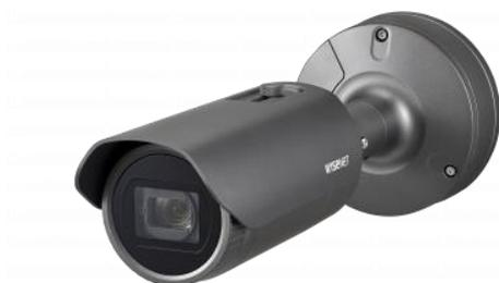
Dovranno essere telecamere fisse di ultimissima generazione con sensore CMOS da 1/2.8" a scansione progressiva da 2 Megapixel 1945 (O) x 1109 (V) e dispositivo WDR 150dB, illuminazione minima 0,015 lux (F1.4) in modalità a colori e 0.00 lux in modalità monocromatica con faro IR attivo e poter trasmettere le relative immagini codificate in H265 / H264 o MJPEG tramite interfaccia Ethernet RJ45.
