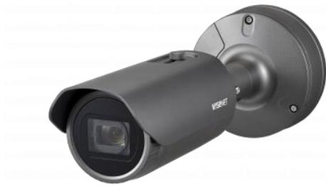
Dovranno essere telecamere fisse di ultimissima generazione con sensore CMOS da 1/2.8" a scansione progressiva da 2 Megapixel 1945 (O) x 1109 (V) e dispositivo WDR 150dB, illuminazione minima 0,003 lux (F1.6) in modalità a colori e 0.00 lux in modalità monocromatica con faro IR attivo e poter trasmettere le relative immagini codificate in H265 / H264 o MJPEG tramite interfaccia Ethernet RJ45.
