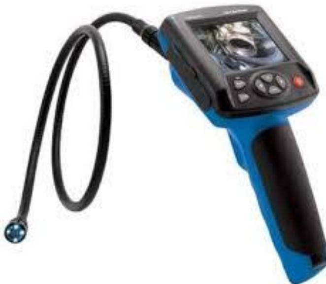
*Le indagini endoscopiche vengono svolte per identificare, senza ricorrere a procedure invasive, le stratigrafie relative ad un componente edilizio (murature, solai) o all'investigazione di cavità inaccessibili e permettono di rilevare anche lo stato dei giunti di malta, infiltrazioni di umidità ed eventuali discontinuità interne.*
