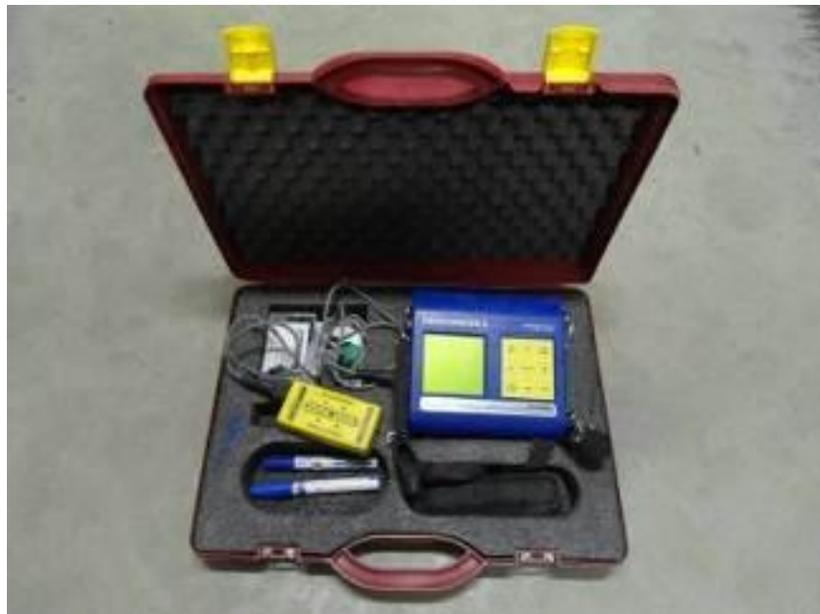
*Il pachometro è uno strumento utilizzato per localizzare in modo rapido ed accurato la presenza e l'orientamento delle barre nel calcestruzzo armato e misurare con buona precisione lo spessore di copri ferro.*
