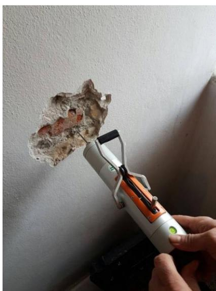
Le misure vanno acquisite sui giunti di malta (n.3 per punto di indagine) opportunamente spazzolati, con lo sclerometro posizionato sempre ortogonalmente alla superficie di prova. Dopo l'infissione dell'ago, tramite un comparatore centesimale, si determina la profondità di penetrazione dello stesso in mm.
