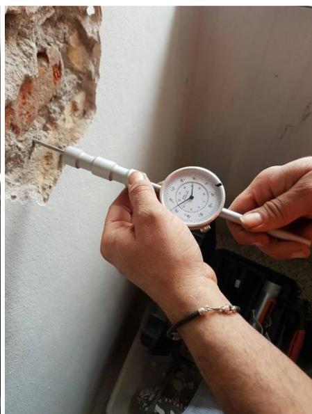
Attraverso l'utilizzo di curve di correlazione infine è possibile ottenere una stima indicativa della resistenza meccanica della malta in rapporto alla profondità di penetrazione. Il valore ottenuti sono puntuali e quindi rappresentativi solo dei punti testati.
