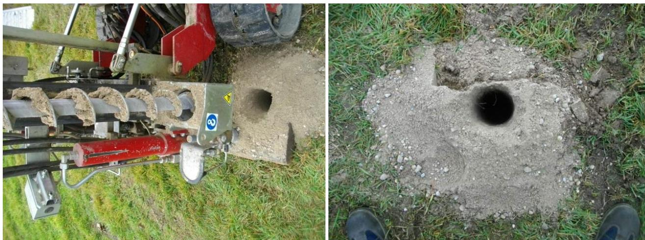
Fotografia 2 effetti di disancoraggio strumento prova statica
